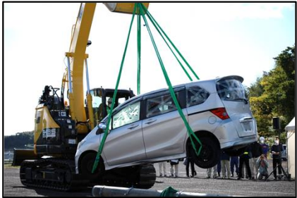
重機による車両の吊り上げ・移動
