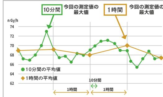
期間中に測定した空間放射線の線量率を、1時間毎、10分間毎に平均して算出し、その中で、最大になったものを表記しています。被ばく線量の推定や評価のため「1時間の平均値」を用い、放射線量の変動をより細かに知るために「10分間の平均値」を用います。(左の図のように10分間の最大値の方が、1時間の最大値より値が大きくなります。)
