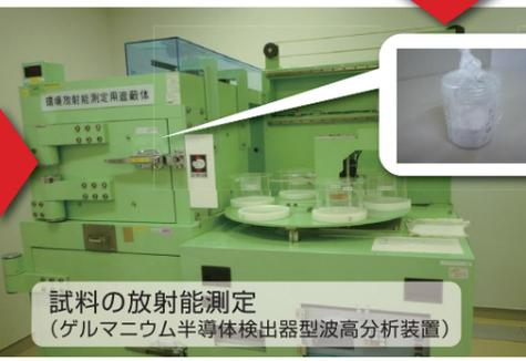
環境放射能調査では、原子力発電所周辺で、県と4市と中部電力が試料を採取し、放射能を測定しています。環境試料中の放射能測定では、きわめてわずかな放射能でも測れるように前処理(乾燥・灰化・蒸発乾固等)を十分に行ってから、放射能測定装置により長時間かけて測定します。
