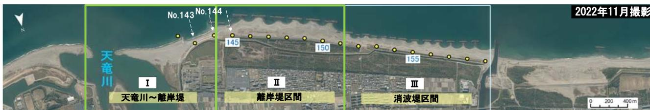
天竜川河口部に整備中の突堤の効果影響を把握するため、突堤周辺の地形変化を突堤整備前の2012年、2014年～整備中2022年11月の空中写真により確認した。
