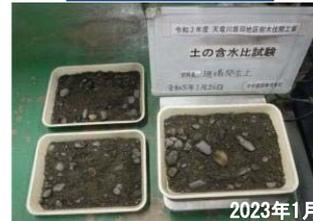
天竜川飯田地区樹木伐開工事の掘削土砂の粒度試験
