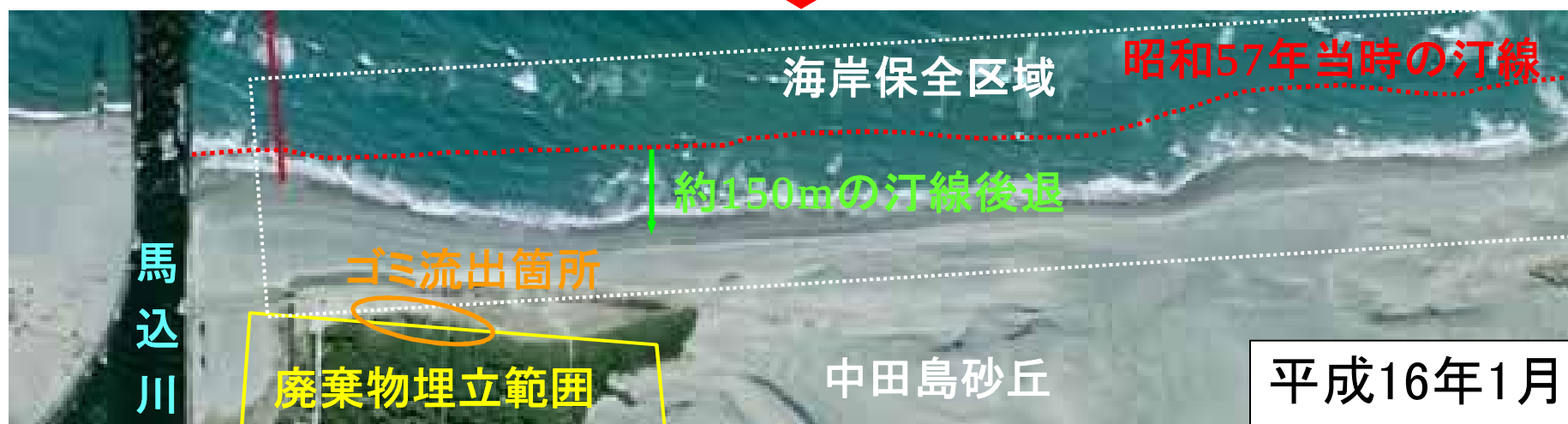
図 空中写真による汀線の変遷(中田島砂丘周辺)
