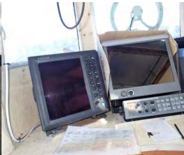
操舵室の内部：魚探、プロッタ
