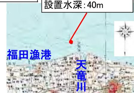
**【遠州灘沿岸海岸の計画外力 (50年確率波)】 : 沖波波高 $H_0=9.0m$ , 沖波周期 $T_0=17.0s$**
