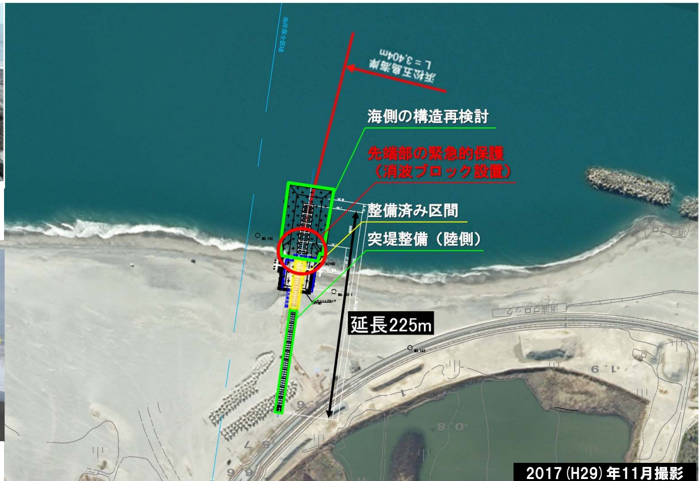
海側の突堤設置予定箇所に転石が散乱しており、計画どおり矢板を打設して突堤を築造することが困難な状況。
