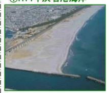
導流堤建設後、東側からの 沿岸漂砂により堆積
