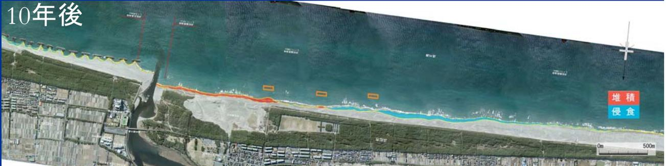
馬込川下手で約100m汀線前進が見込めるが、下手では180m汀線が後退
