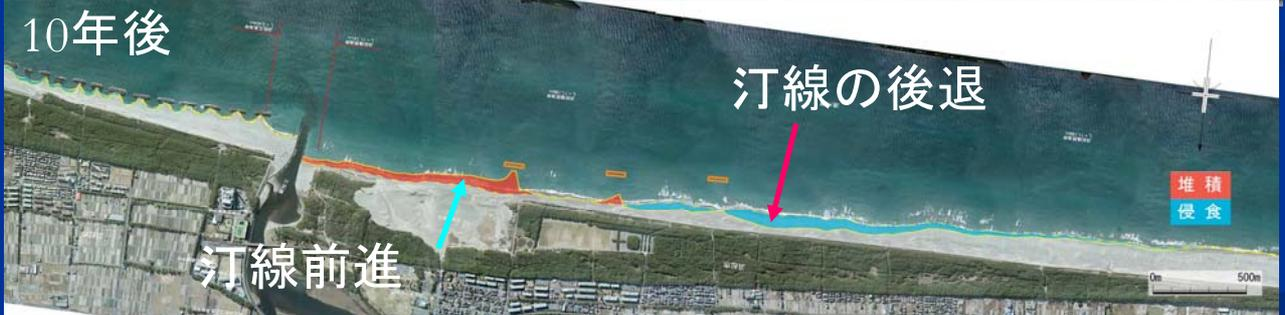
馬込川下手で約50m汀線前進が見込めるが、一番下手では70m汀線が後退
