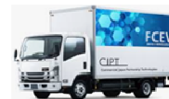
燃料電池トラック（4トン車）
