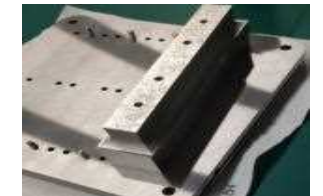
金属3Dプリンタで 製造した高放熱金型
