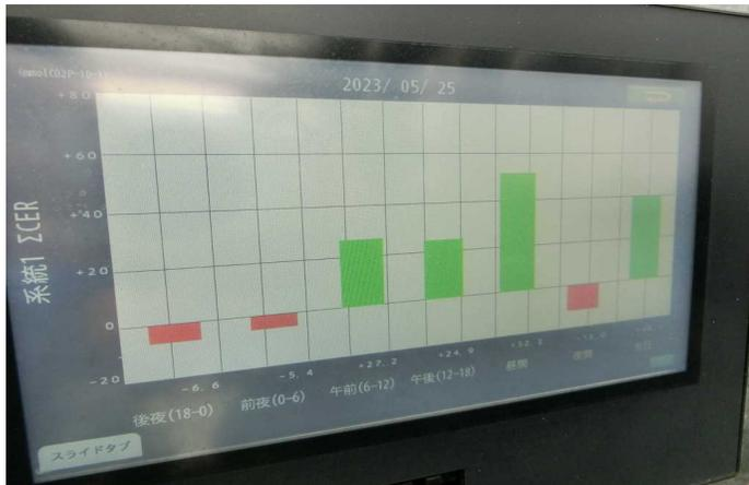
温度、湿度、CO<sub>2</sub>濃度、光量、葉面積データから、光合成量及び蒸散量を推定し、当日午前・午後の光合成量等を表示します。推定モデルに基づき、光合成を増やすための栽培管理を提示します。
