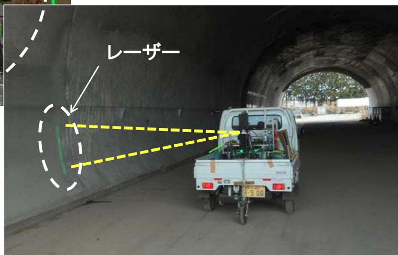
時速30km/hでひび割れ(幅、段差)
