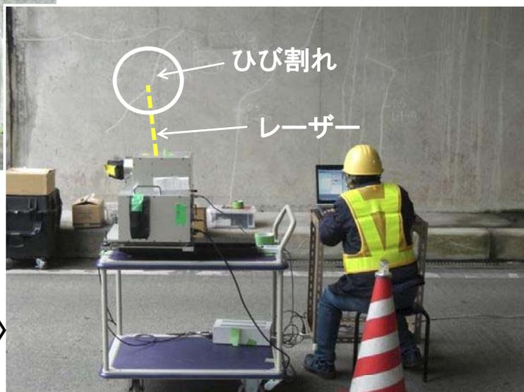
実際のひび割れ(幅、段差)を計測
