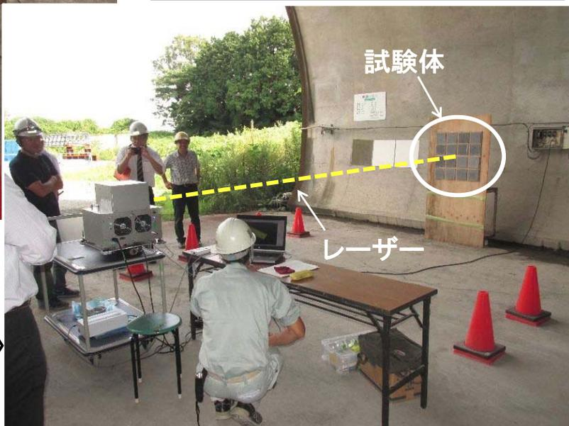
試験体のひび割れ(幅、段差)の計測
