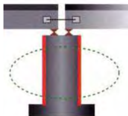
橋脚コンクリート 巻き立て補強
