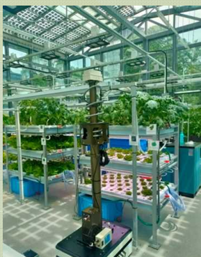
Inspection of plants with telescopic mast 伸縮マストを使用した植物の点検
