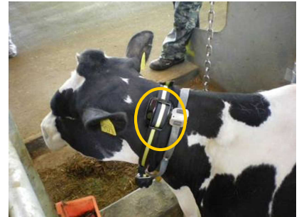
反すう時間を計測する音響 センサー
