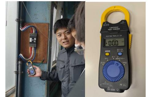
クランプメーターによる電流測定
