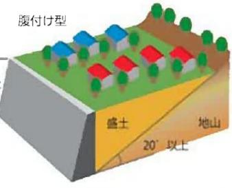
盛土をする前の地山の傾斜が20以上の急な斜面で、高さ5m以上の盛土を行った宅地
