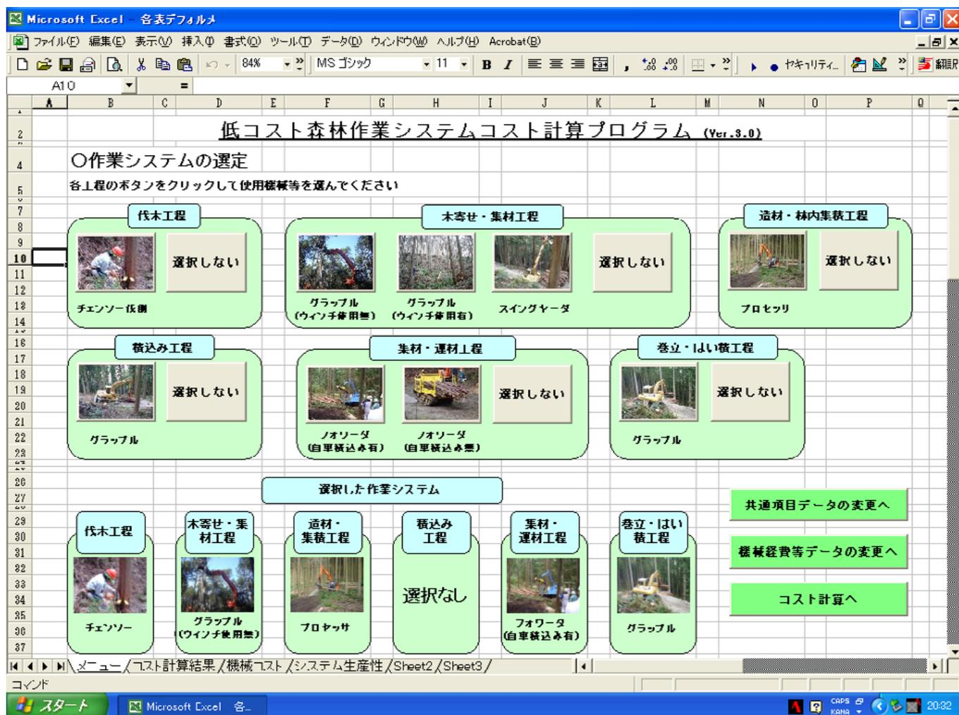
高性能林業機械を使った木材搬出作業が各地で行われるようになってきました。しかし、これらの機械を組合せて作業を行った場合、木材搬出にかかるコストの計算が大変でした。
