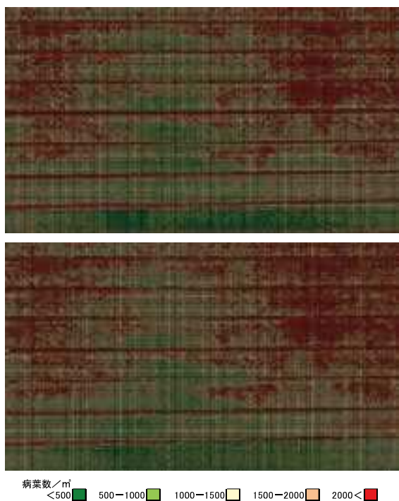
図2 原図(図1)を元に炭疽病の病葉密度( y )を10×10ピクセル単位で500枚ごと5段階に色分けした画像。推定式は、上: y = -90.41(G - R) + 2745.55 、下: y = 8982.61((R + G)/G) - 15265.13 を適用。RおよびGは各分画区における色データの平均値
