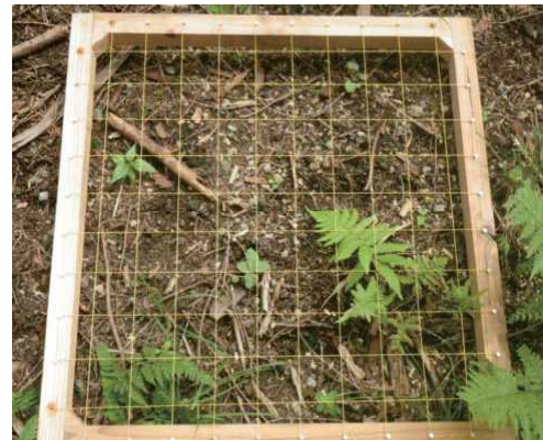
写真2 土砂受け箱エプロン板の前に置いたポイントカウンティング用木枠
