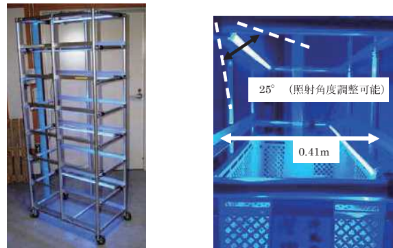
図1 考案した青色LEDコンテナカート(左)とテープLED取り付け位置・角度(右)。
