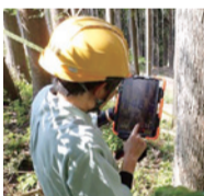
携帯端末による森林計測 タブレットの機能を活用して立木の直径や位置情報を計測、伐採計画の作成などに利用
