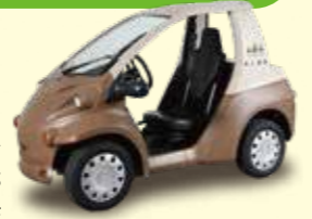
「植物素材「TABVID®」を使用した超小型BEV」トヨタ車体(株)もくまる
