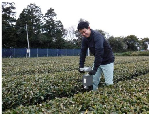
図2 土壤硬度測定時の様子
