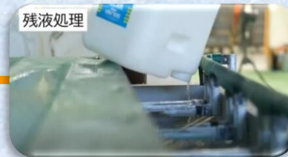
残液処理 容器内の残液を抜き取る 残液は廃水処理施設にて 活性汚泥処理
