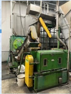
破碎機にて 湿式破碎
