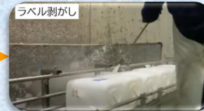
ラベル剥がし 高圧温水で一気に剥がす
