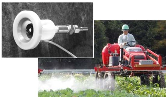
図1 ブームスプレーヤ型静電散布機と同ノズル部
