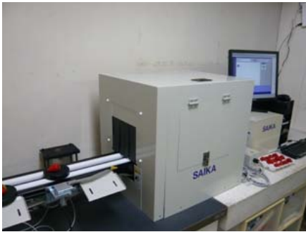
図1 イチゴ用ライン型非破壊糖 度測定機
