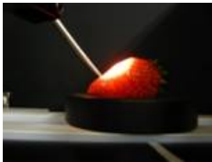
図3 イチゴ非破壊測定時の 光源の照射角度
