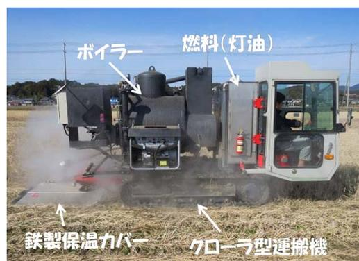
第1図 自走式蒸気処理防除機
