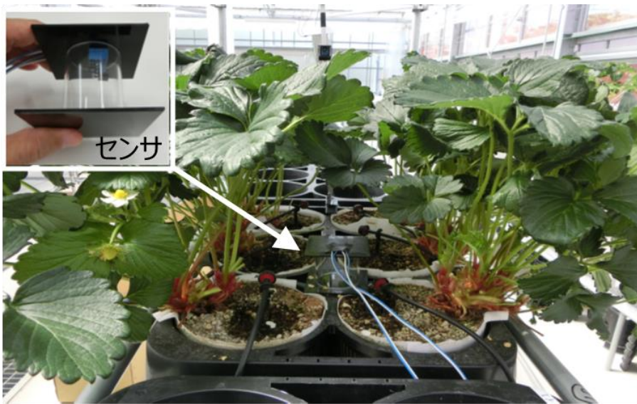
図2 イチゴ株間に設置した葉面積評価センサ
