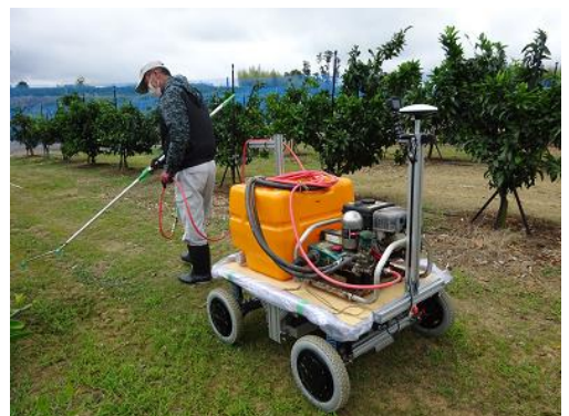
作業者に自動追従するロボットと機械化に対応した垣根型樹形の開発
