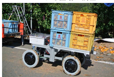
無人走行する「運搬ロボット」
