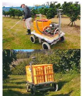
写真3 作業員に自動追従したり自律走行で運搬するロボット
