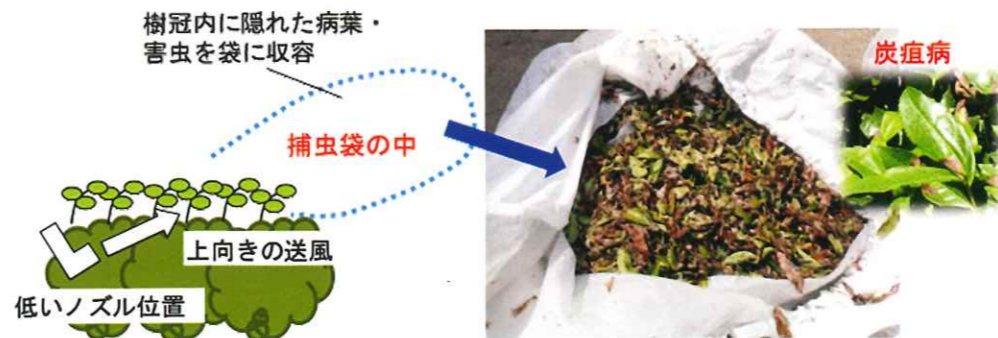
図2 茶園用病害虫クリーナーの病害虫防除方法の概略と捕虫袋への病害虫の収容
