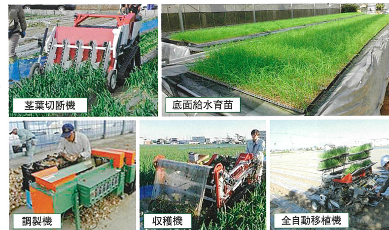
写真1 開発されたタマネギ機械化一貫体系
