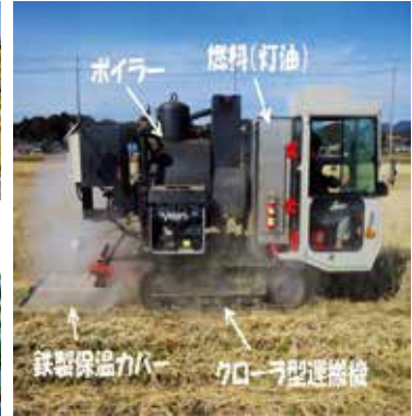
小麦作における難防除雑草対策技術の開発（蒸気除草機）
