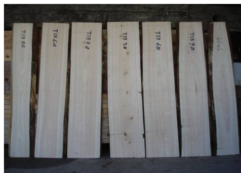
ヒノキ根元材から採取した板
