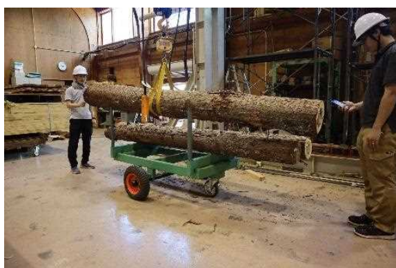
無拘束状態で測定 (1本ずつ吊り下げた状態)
