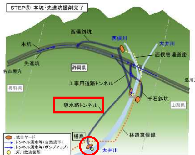
図 1.29 トンネル湧水等の流れ、河川への放流箇所 (STEP⑤) 7
