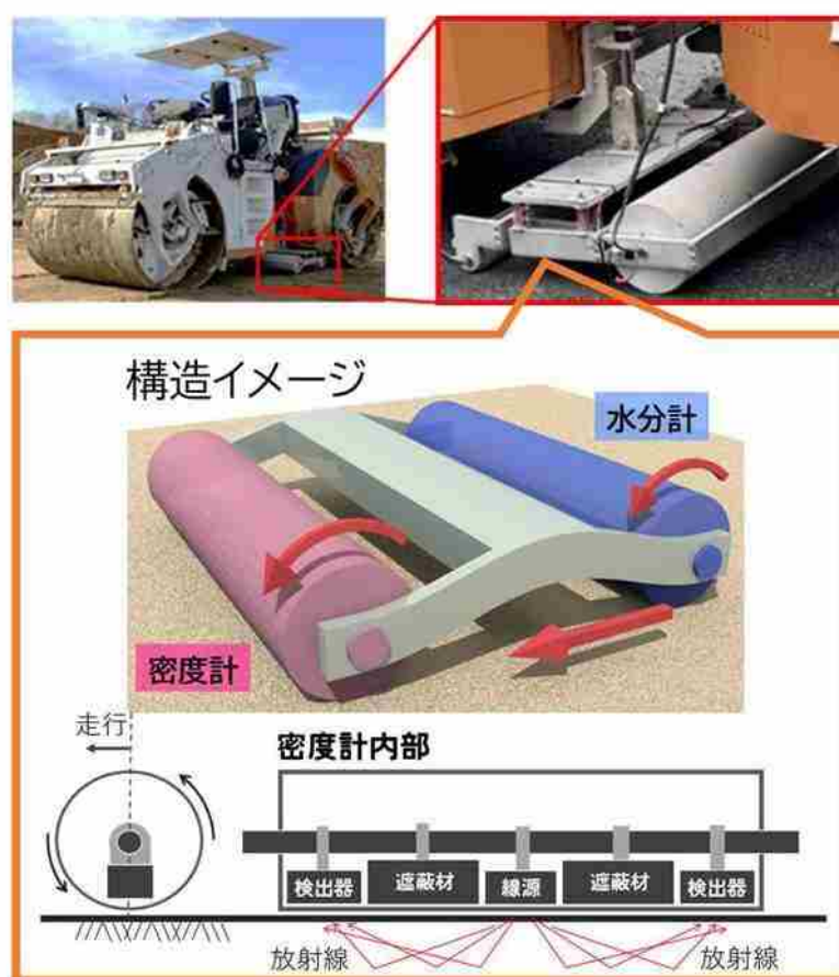
図 99 締固め度自動計測システムのイメージ
