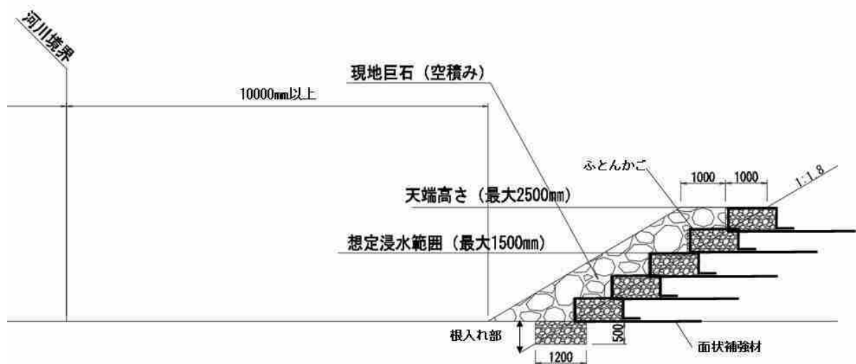
図 9 7 盛土法尻構造物詳細図
