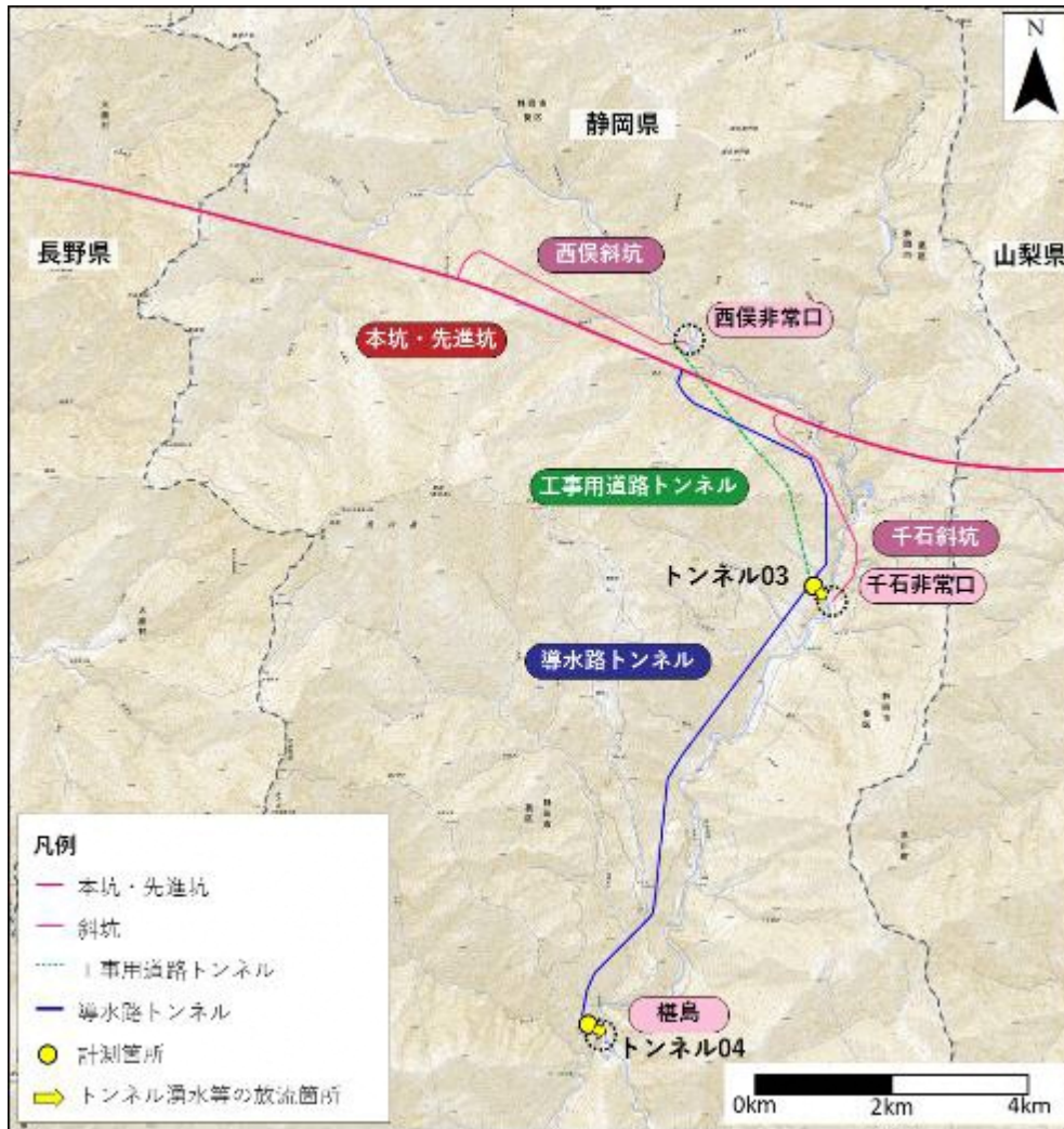
図 16 トンネル湧水等の計測箇所、放流箇所（工事完了後）
