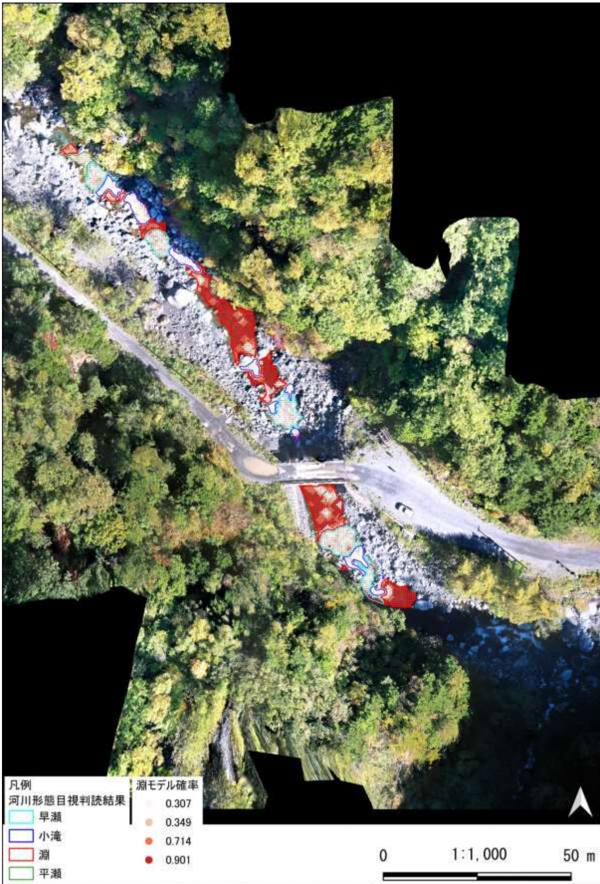
図 16 湍の決定木モデルの河川への適用結果 (UAV 撮影画像：西俣川 (柳島付近))
