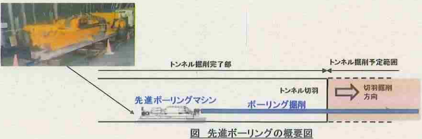
図 先進ボーリングの概要図
