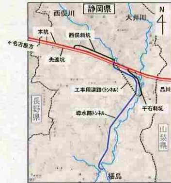
図 静岡県内のトンネル工事概要
