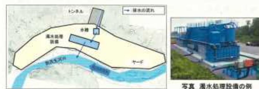
図 トンネル湧水の濁水処理の流れ(イメージ)
