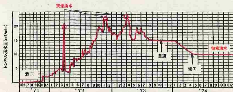
図 トンネル湧水量の工事中・工事後の変動(福岡トンネル(山陽新幹線))
