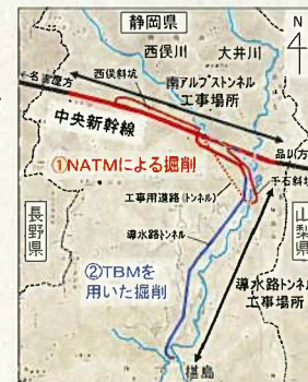
図 静岡県内のトンネル工事概要
