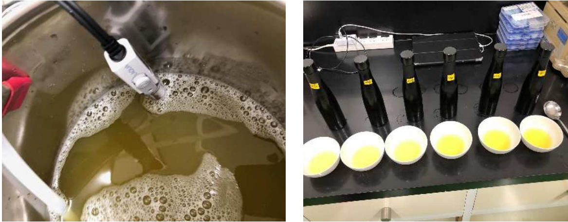
電解還元装置を用いたボトリングティーの賞味期限延長試験
