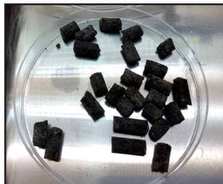
写真3 直径6mmの市販泥炭ペレット(南榛原株式会社製)
