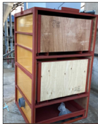
写真7 上下二段式の充填カゴ構造
