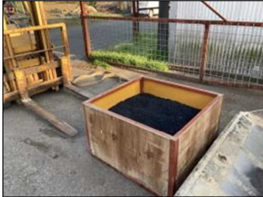
写真8 フォークリフトによる充填カゴ取替
