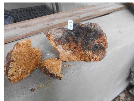
図13 破損したシイタケ菌床 (廃菌床割合 100%)
